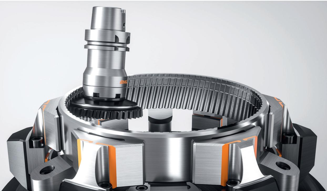
1 Aktuelle Komplettlösungen zum Wälzschälen von Emuge-Franken vereinen Prozesskomponenten wie Werkzeugspannung, Werkzeug und Werkstückspannung zu einem prozessoptimierten Gesamtkonzept
